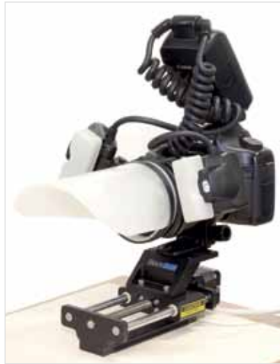
Primeira imagem, plataforma de empilhamento com trilho de foco automático, trilho de foco simples e suportes para posicionamento da iluminação, além de câmera fotográfica com fole e lente macro 35mm. Segunda imagem, plataforma de empilhamento com trilho automático e difusor artesanal para iluminação
