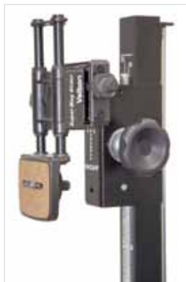
Na primeira foto, dois modelos básicos de trilho de foco, um em formato "X", e outro simples. Ao lado, trilho de foco simples montado sobre cabeça de tripé. Abaixo, trilho de foco simples montado em coluna de mesa de cópia artesanal
